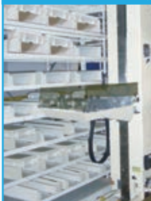
ケース自動ピッキングシステム(メディカルクレーン)
